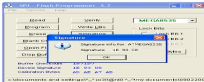
**Gambar 4.1** Pengujian ATMEGA 8535 menggunakan SPI Flash Programmer
